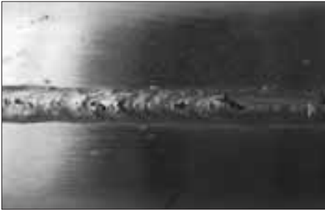
Figure 5.11. Slag islands – MIG 316L-Si
